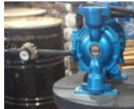
4. ATTACH AIR REGULATOR ON TO THE SIDE OF THE PUMP
