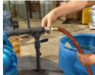
5. ATTACH HOSE ON TO THE FITTINGS ON THE SIDE OF THE PUMP
